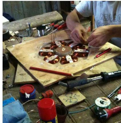
**électricité et résine** (fabrication de la génératrice discoïde, branchements électriques...).
